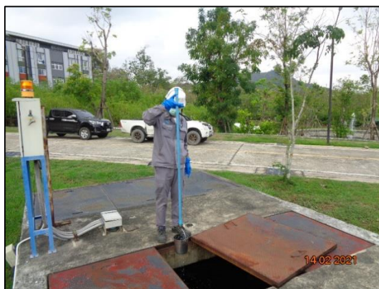
รูปที่ 3.1 การเก็บตัวอย่างคุณภาพน้ำทิ้ง บริเวณ บ่อบำบัดน้ำทิ้งก่อนระบายออกนอกโครงการ
